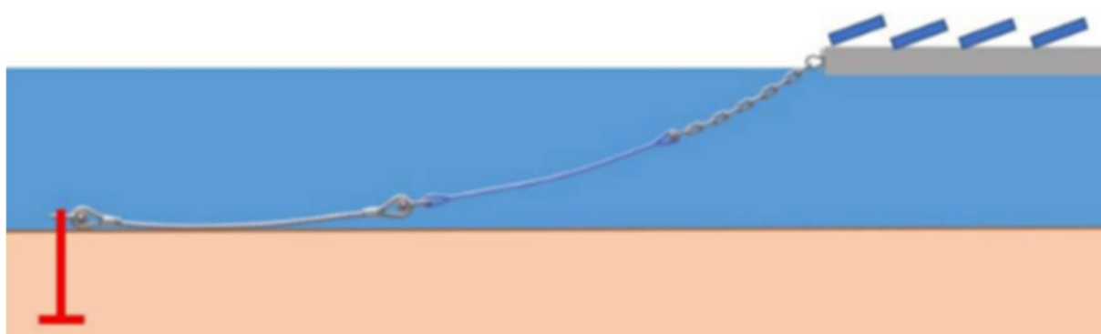
Figure 4 – Représentation schématique d'un ancrage en fond (source : Ciel & Terre)
